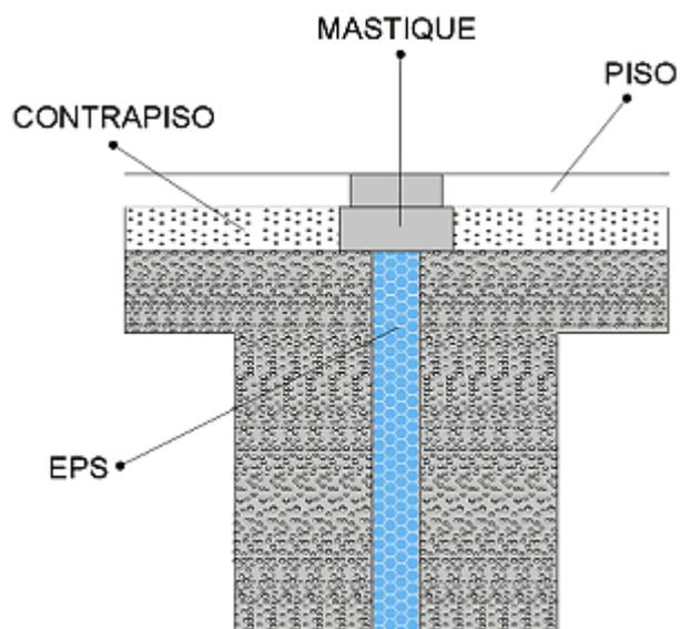
*Ao se concretar uma estrutura com junta de dilatação, o primeiro lance a ser concretado utiliza formas convencionais. Ao se concretar o segundo lance, usam-se placas de EPS como forma entre as partes.*
